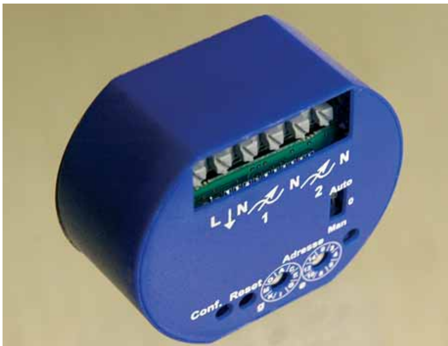
Rys. 2. Moduł (aktor) pozwalający sterować dwoma obwodami
