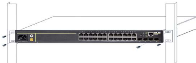
Fig 2-2 Mocowanie przełącznika w stelażu
