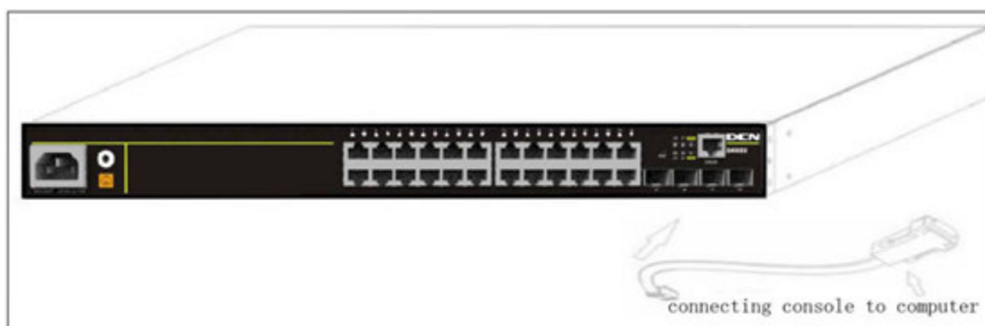
Fig 2-3 Podłączenie do konsoli przełącznika
